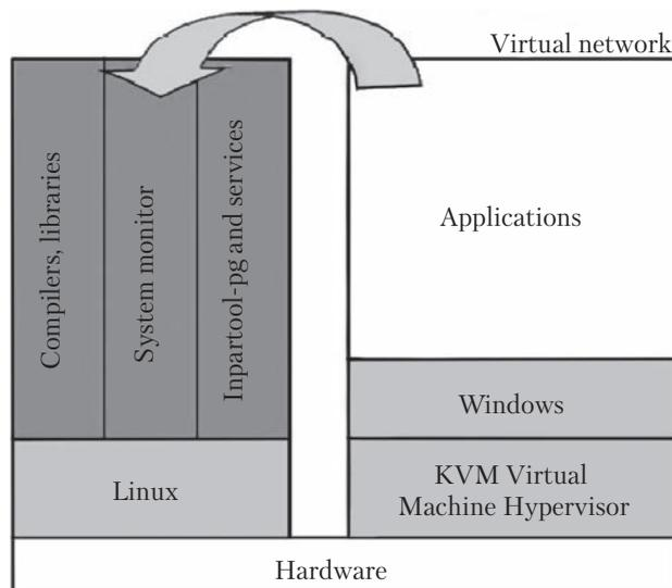
**Fig. 3.** Configuration of «Inparcom-pg» system software
